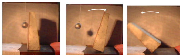
①擁壁に衝突 ②前方へ回転 ③後方へ転倒
