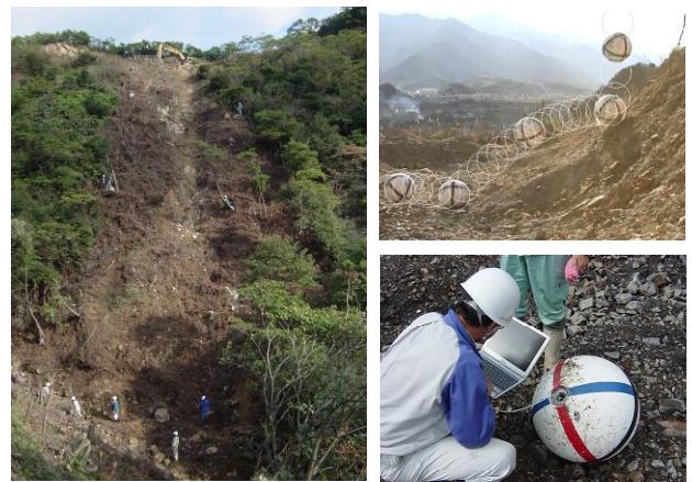
図 5 実斜面での落石実験
