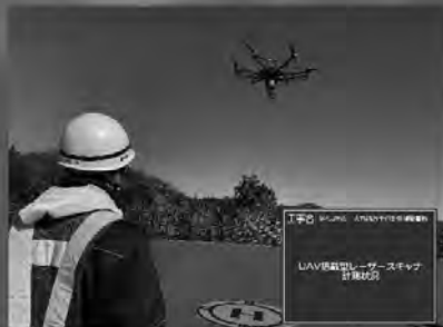
UAVレーザー計測
